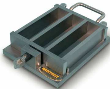
Трехгнездовая форма для изготовления образцов-балочек размером 4×4×16 см
