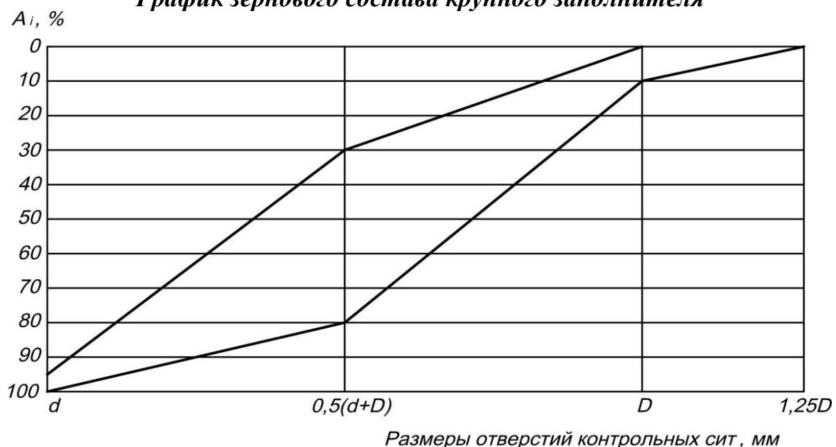
График зернового состава крупного заполнителя
