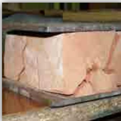
Рис. 2. Результаты испытаний первой серии образцов
