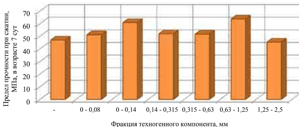
Рис. 1. Влияние фракционного состава техногенного компонента на прочность композиции
