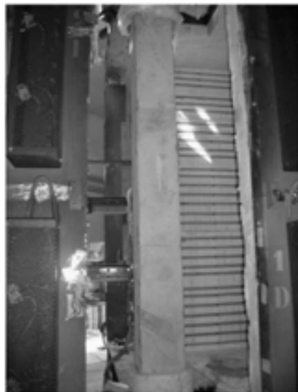
Рис. 1. Железобетонная колонна с полипропиленовой и стальной фиброй (С4)
