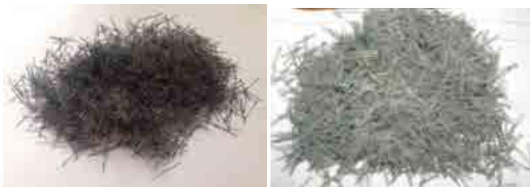
Рис. 1. Образцы полимерной жесткой фибры:
