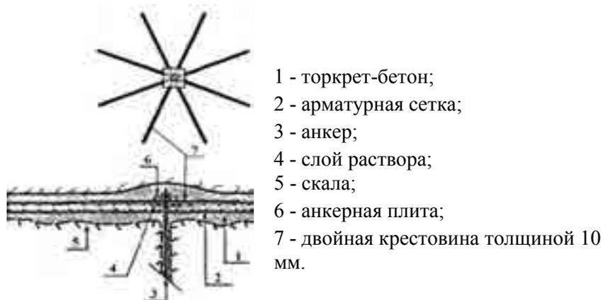
Рис. 3. Армирование в области анкерной головки
