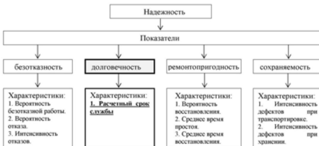
Рис. 1. Структура показателей надежности строительных объектов
