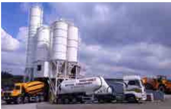
Рис. 3. Современный бетонный узел с обеспыливающими устройствами
