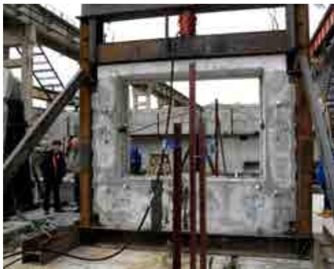
Рис.3. Испытания простеночных частей
