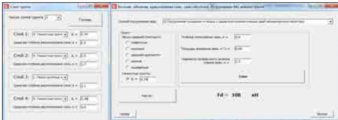
Рис. 3. Расчет забивной сваи по программе «Pile Load»
