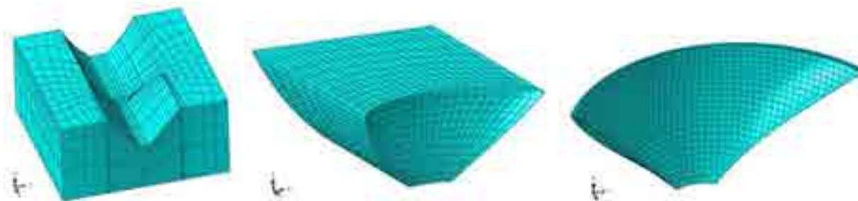
Рис 1. Конечноэлементная модель системы "основание - водохранилище - арочная плотина"
