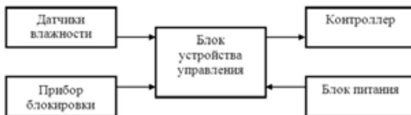
Рис. 3. Структурная схема блока управления системы МДД
