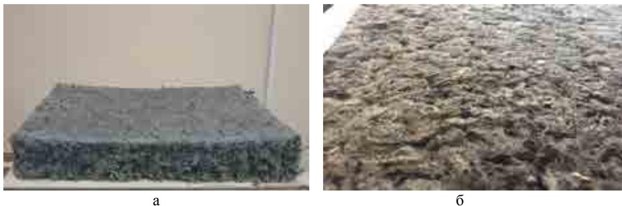
Рис. 2. Теплоизоляция на основе текстильного корда. Внешний вид образца (а) и поверхность образца (б)
