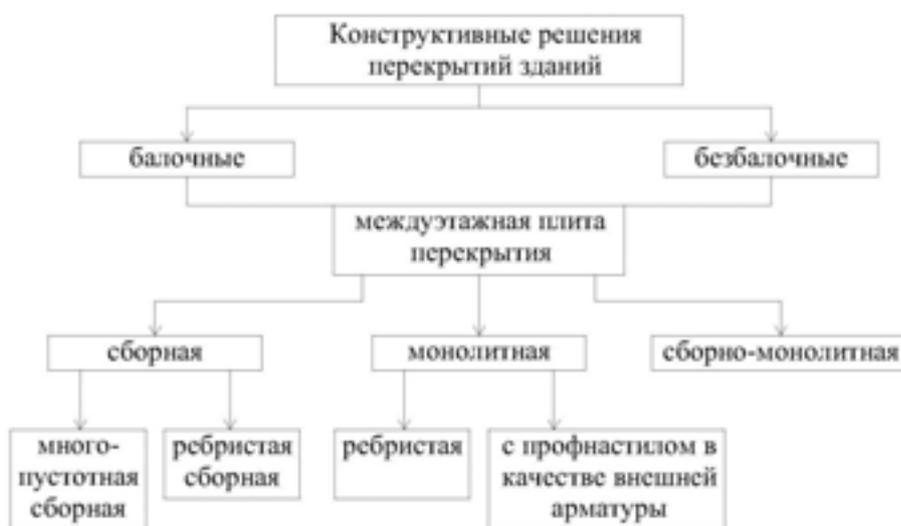
Рис. 1. Конструктивные решения междуэтажных перекрытий при реконструкции
