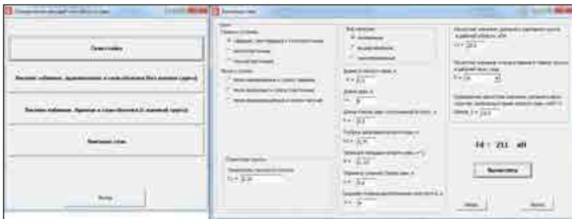
Рис. 1. Расчет несущей способности сваи в программе «Pile Load»
