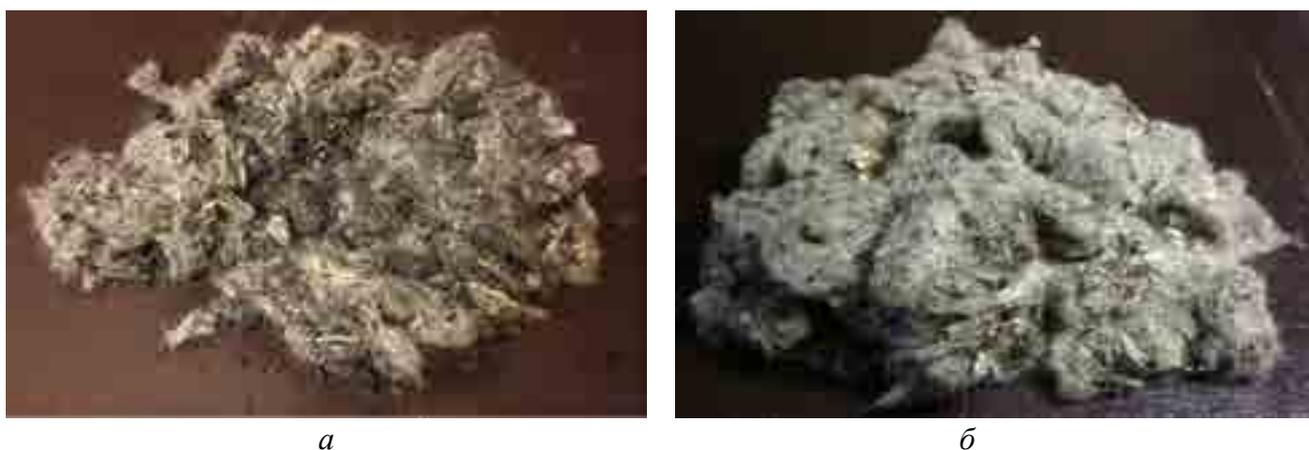
Рис. 1. Текстильный корд до очистки (а) и после очистки (б)
