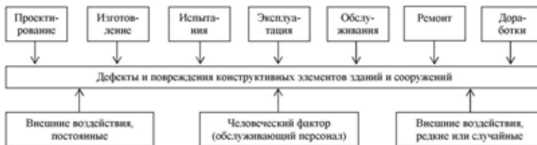
Рис. 3. Структура групп факторов, которые приводят к накоплению дефектов и повреждений элементов строительных конструкций зданий и сооружений
