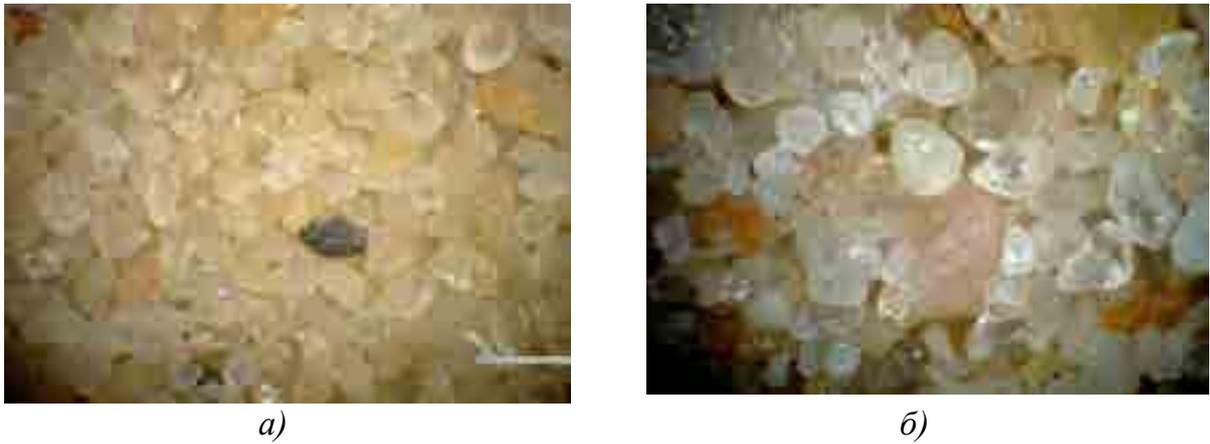
Рис. 2. Особенности формы и характера поверхности частиц песчаного грунта для однородного (а) и неоднородного (б) грунта (Мирный А.Ю., 2015) [3]
