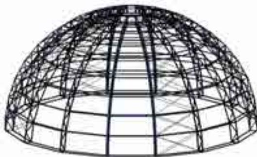
Рис. 1. Запроектированный каркас исследуемого ребристо-кольцевого купола
