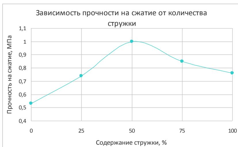
Рис. 1. Определение наиболее плотной упаковки опилок в сырьевой смеси
