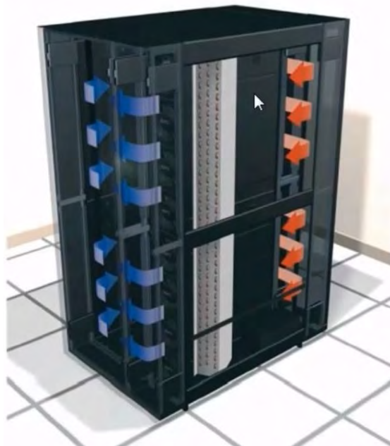
Рис.5. Схема охлаждения на уровне стоек.
