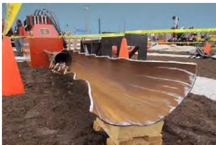
Рис.3. Разрезание стальной трубы с помощью резака с одной режущей кромкой
