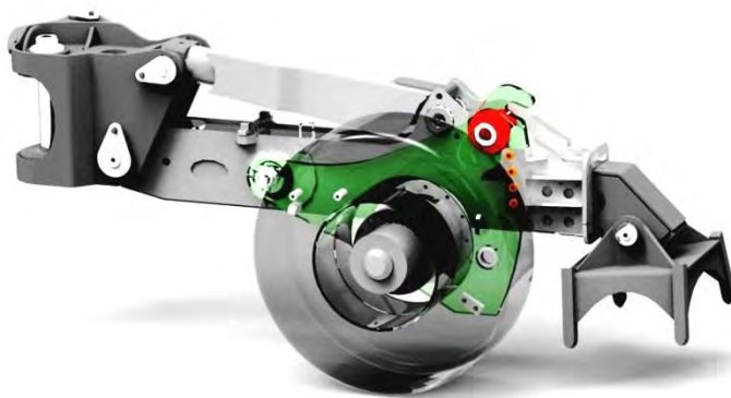
Рис. 1. Гидравлически регулируемая лафета (теленога) (3D модель)
