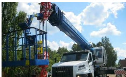
Рис. 3. Рабочая поворотная платформа для обеспечения строительно-монтажных и ремонтных работ
