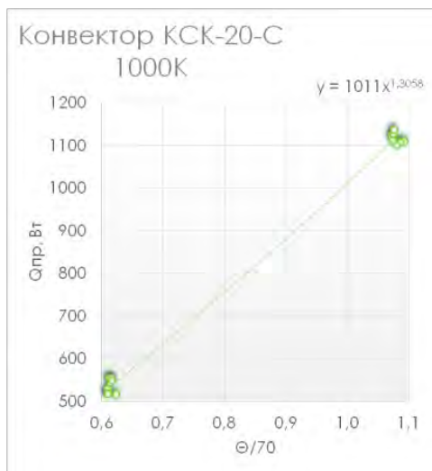
Рис.2. Зависимость изменения теплоотдачи конвектора от изменения температурного напора для конвектора КСК-20-С 1000К
