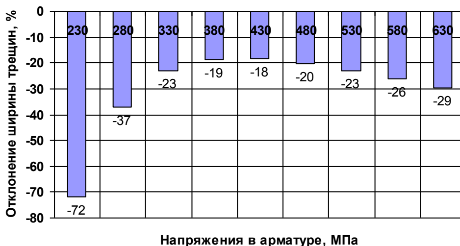
Рис. 2. Отклонения ширины раскрытие трещин в балках ( \Delta_a )
