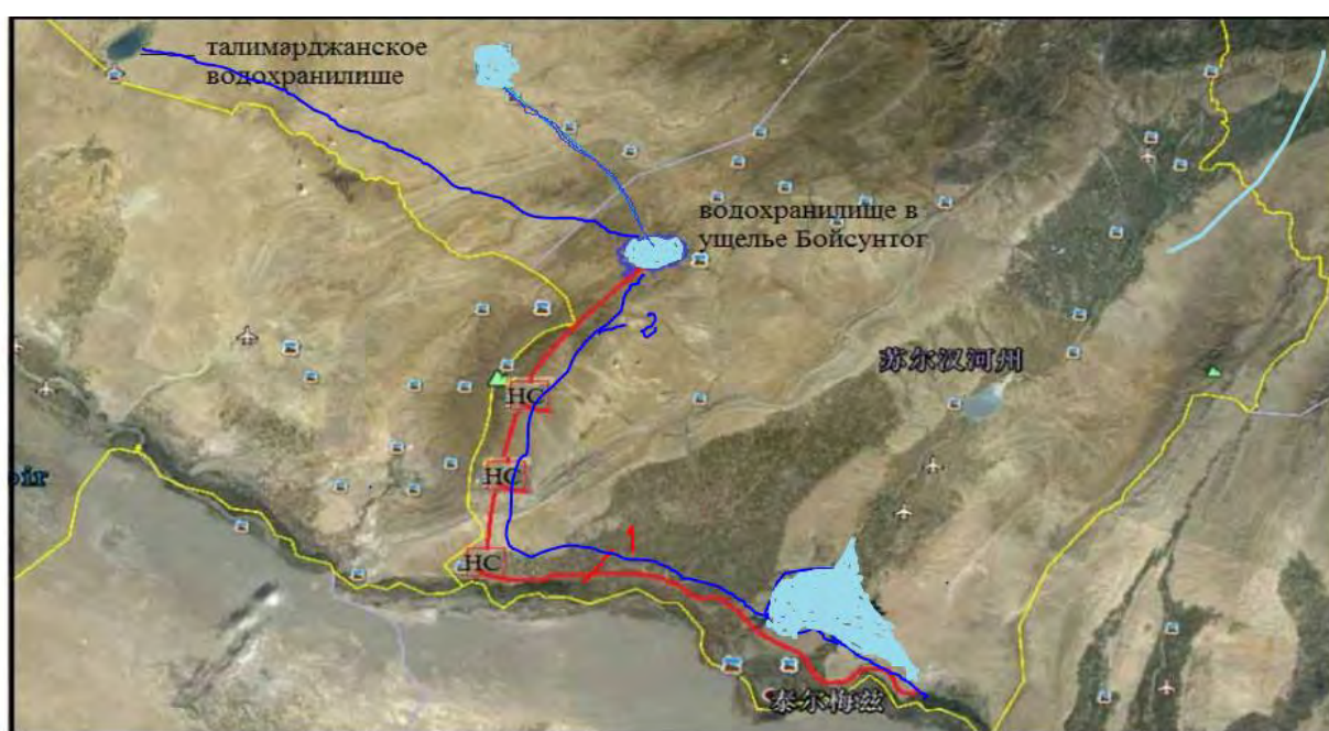
Рис. 2. Предлагаемые варианты переброски вод Амударьи к южным областям Узбекистана (в Сурхандарьинскую, Кашкадарьинскую, Бухарскую, Навоийскую области)
