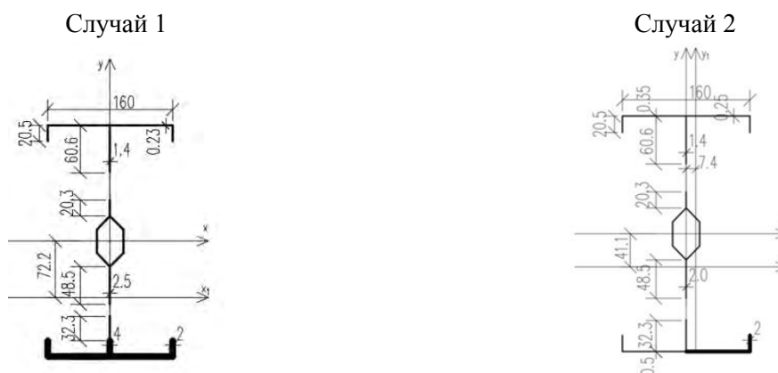
Рис. 4. Эффективное поперечное сечение элемента при сжатии с изгибом с учетом начальных геометрических несовершенств
