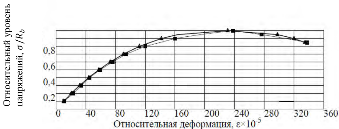
Рис. 3. Полная диаграмма деформирования бетона \sigma/R_b - \varepsilon (2 серия): ■- эксперимент; \Delta -по формуле (1)
