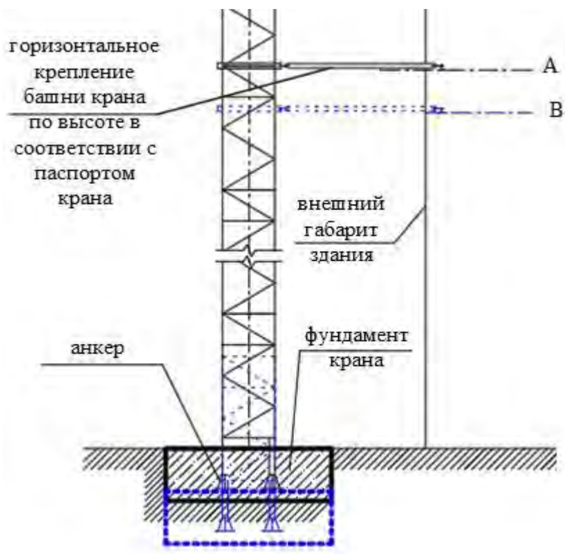
Рис. 1. Условная схема горизонтального крепления стационарного башенного крана на фундаментной плите (вариант В)
