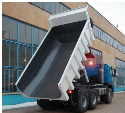
Рис. 1. Футеровка кузова самосвала с полимерным покрытием для защиты
