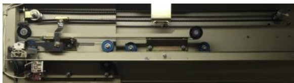
Рис. 4. Конструкция привода дверей после модернизации
