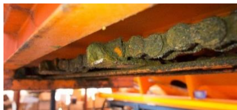
Рис. 1. Пример состояния пластинчатой цепи конвейера, несколько месяцев проработавшей с песко-соляной смесью
