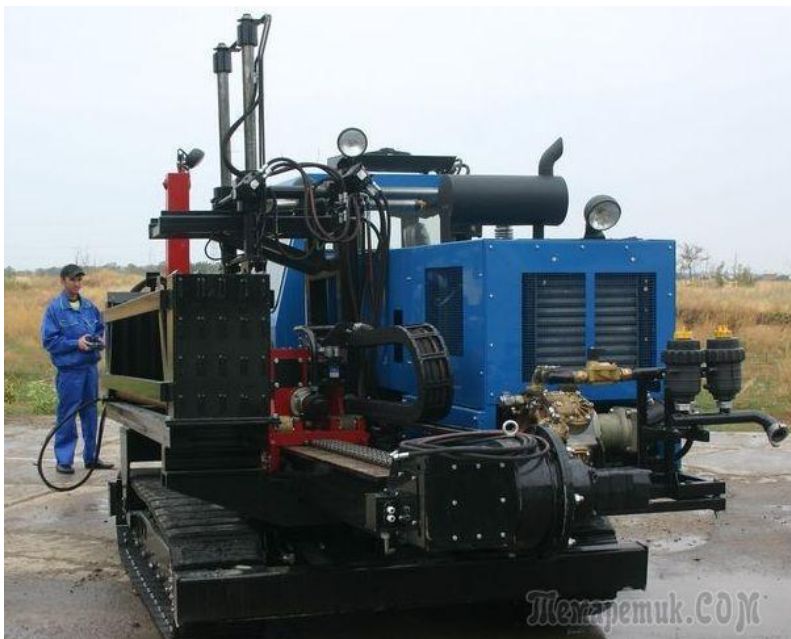
Рис. 1. Установка глубинного направленного бурения
