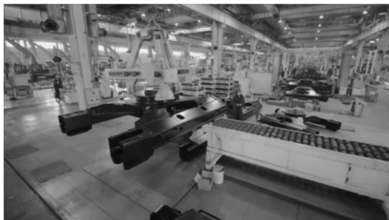
Рис. 1. ГЗП для подъёма рамы экскаватора
