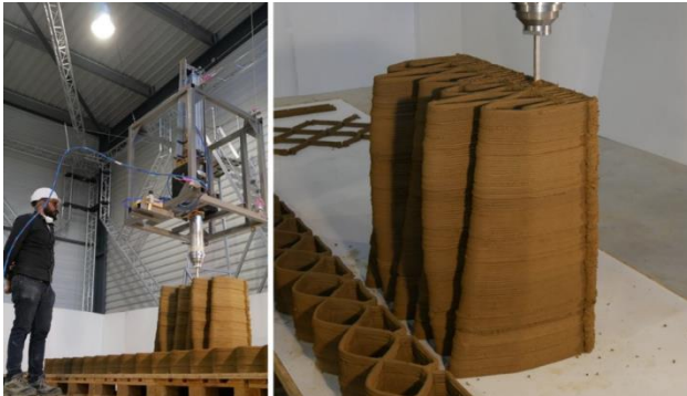
Рис. 9. Процесс печати экспериментального образца [12]
