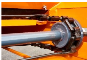
Рис. 2. Пример решений от зарубежных производителей: скребковый транспортёр с двумя круглозвенными цепями Rasco, Хорватия (слева) и скребковый транспортёр с двумя цепями особой конструкции Bucher Municipal, Швейцария (справа)
