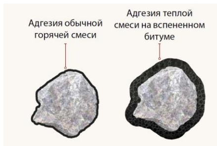
Рис. 3. Адгезия тёплой смеси на вспененном битуме
