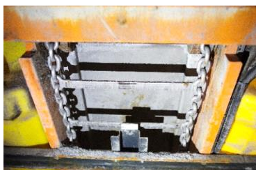
Рис. 2. Пример решений от зарубежных производителей: скребковый транспортёр с двумя круглозвенными цепями Rasco, Хорватия (слева) и скребковый транспортёр с двумя цепями особой конструкции Bucher Municipal, Швейцария (справа)
