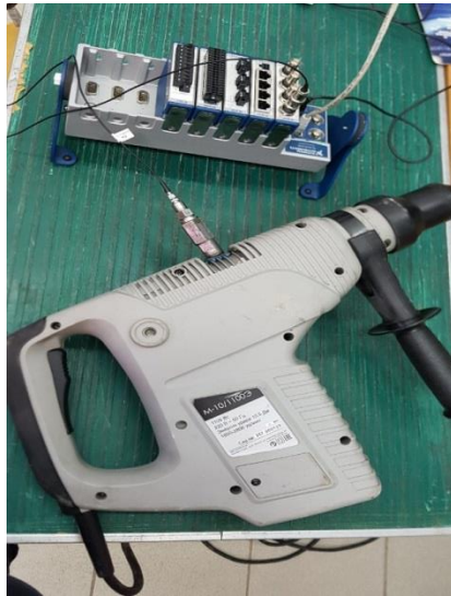
Рис. 1. Использовался датчик PS2001-250 с чувствительностью 250 мВ/бар, с положительной полярностью, с измеряемым диапазоном от 0,01 до 25 Мпа
