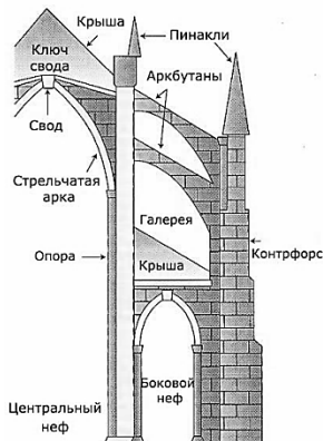
Рис.2 Каркас собора эпохи ранней готики.
