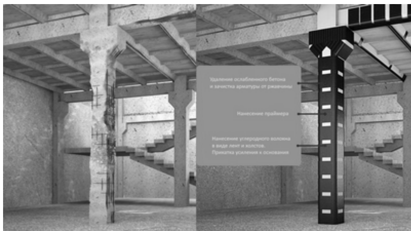
Рис. 3. Усиление колонны углеродными лентами
