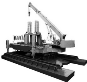
Рис.1. Сваявдавливающая машина Sunward 320
