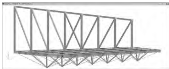
Рис.2. «zipper» ферма с прилегающими стальными фермами.
