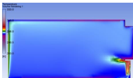
Рис. 4. Модель распределения температур в объеме помещения
