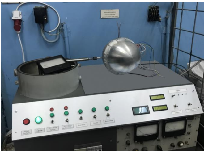
Рис. 6. Общий вид экспериментальной установки для получения вакуума и исследования его влияния на теплозащитные свойства купольной оболочки
