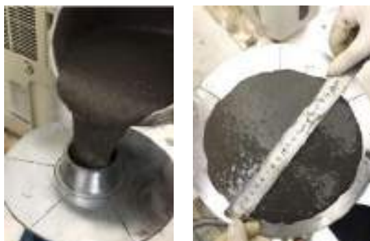
Рис. 1. Определение удобоукладываемости мелкозернистых бетонных смесей по расплыву конуса
