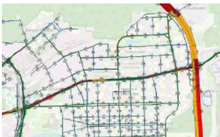
Рис.1. Макромодель транспортных потоков ВАО в утренний час «пик» в программном комплексе ЕММЕ
