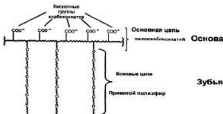
Рис. 1. Строение молекул поликарбоксилатных суперпластификаторов
