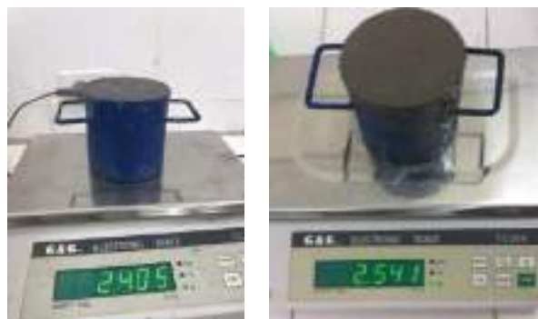
Рис. 2. Определение плотности мелкозернистых бетонных смесей
