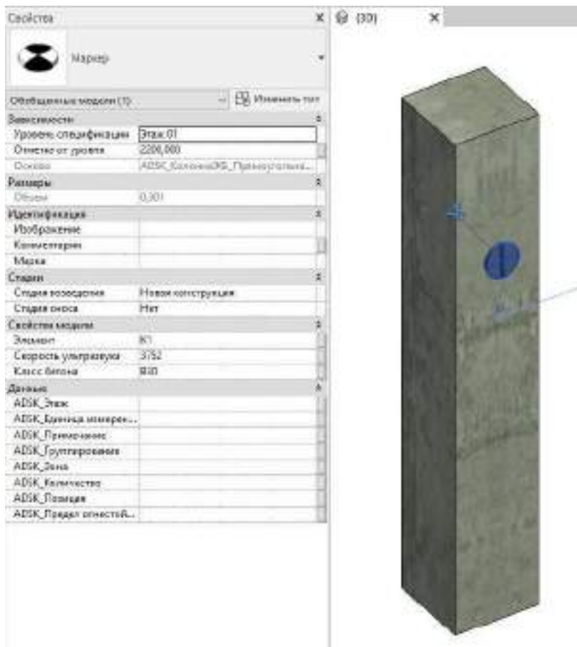
Рисунок 5 – Железобетонная колонна с маркером проведения ультразвукового испытания
