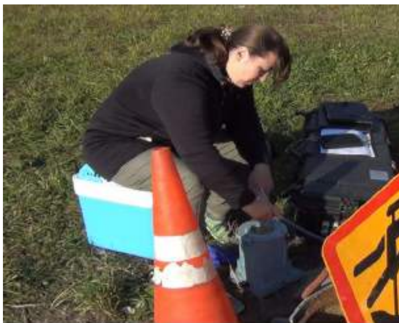
Рис.2. Отбор проб для микробиологическое исследование воздуха с помощью прибора Кротова из канализационного колодца
