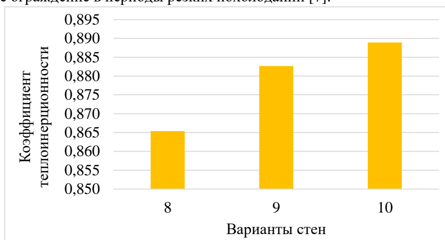
Рис. 6 Коэффициент теплоинерционности наружной стены для 8 – 10 вариантов.
