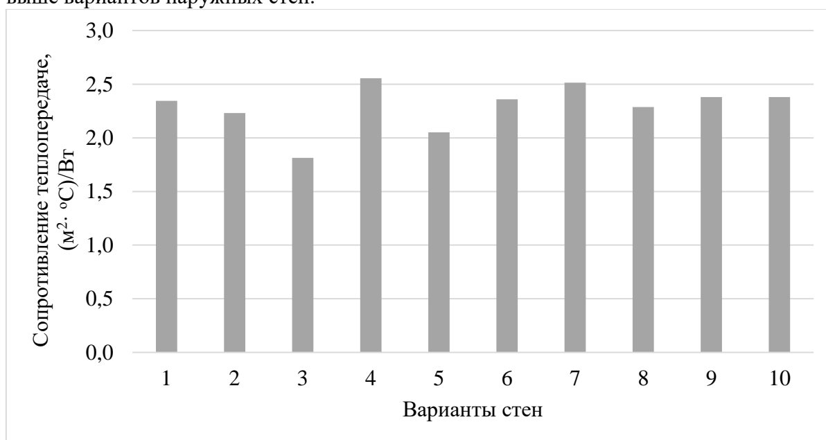
Рис. 1 Сопротивления теплопередаче наружной стены для 1 – 10 вариантов.
