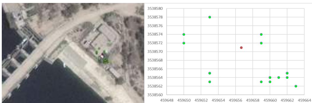
Рис.3. Проекция наблюдаемых значений (координат КТ) на спутниковое изображение
