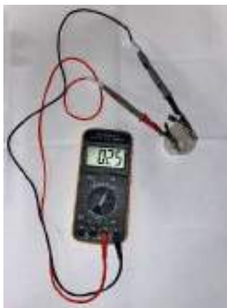
Рис. 1. Измерение сопротивления образца
