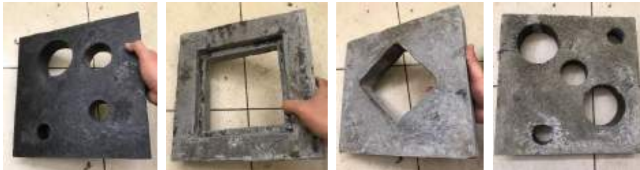
Рис. 4. Вентиляционные решетки из мелкозернистой бетонной смеси на разработанном бесцементном вяжущем
