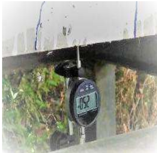
Рис. 4. Измерение деформаций балки прогибомером (Digitaldailgauge)
