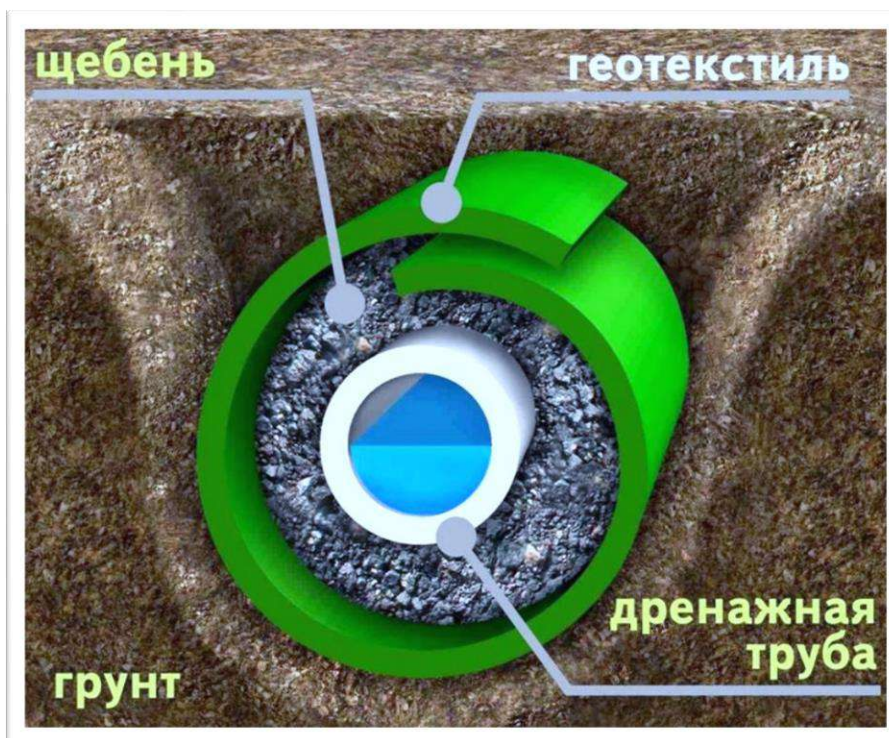
Рис. 2. Пример дренажной трубы с фильтром из геотекстиля и с засыпкой в виде щебня
