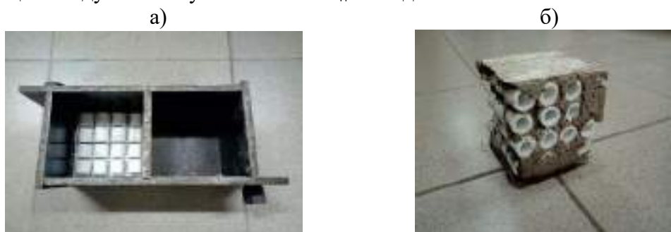
Рис. 3. Модельные образцы: а) – на этапе формования; б) – образец с 40% содержанием трубчатых вкладышей после испытания на прессе.
