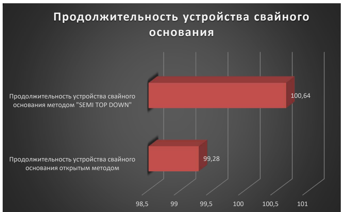
Рис. 2 Диаграмма продолжительности производства работ по устройству свайного основания
