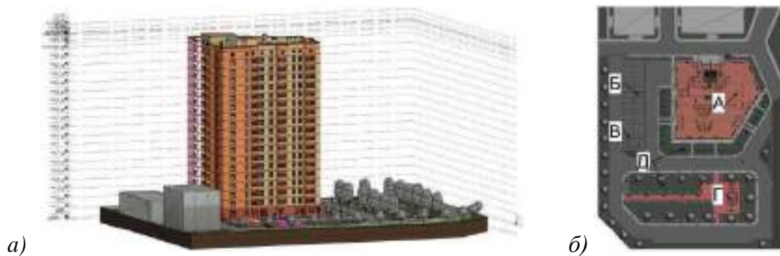
Рис. 5. Модель 3D организации строительства здания: а) Перспектива; б) Генеральный план 1:600. А- Здание, Б- Обозначение машиномест, В- Место для маломобильных групп населения, Г- Десткая площадка и площадка для занятий физкультурой, Д- Газонное покрытие и деревьев
