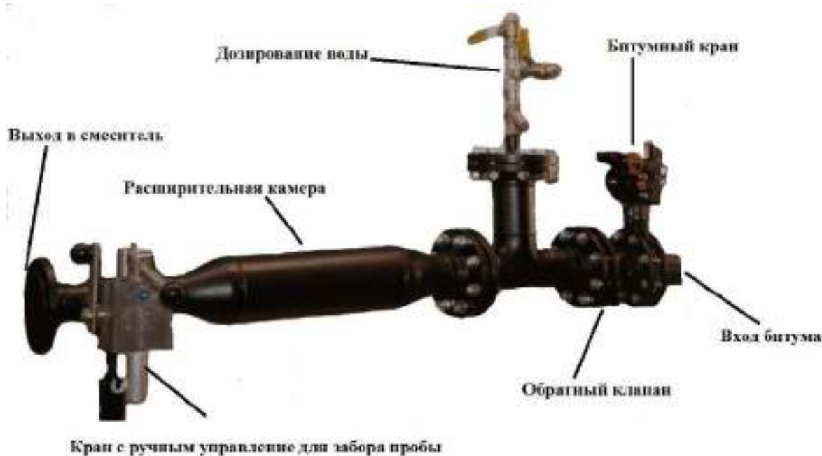
Рис.1. Узел вспенивания битума
