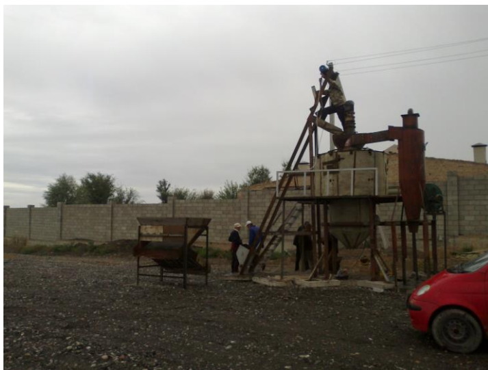
Рис. 2. Общий вид пиролизной установки кипящего слоя
