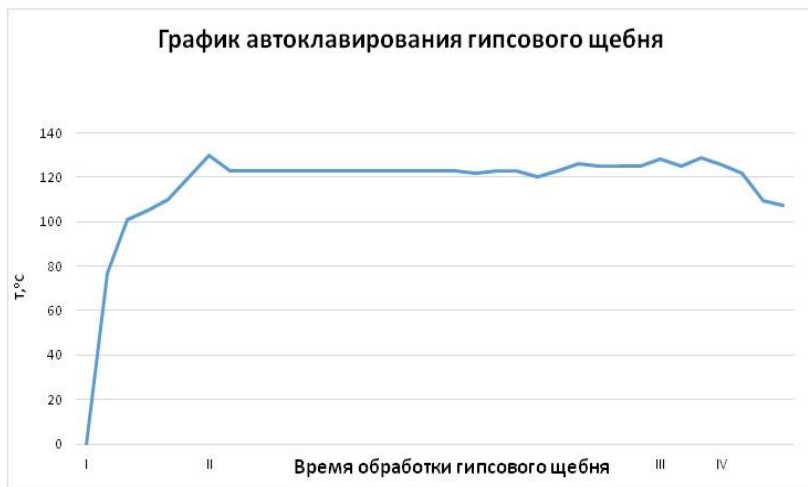
Рис. 2. Технологический процесс автоклавирования гипсового камня
