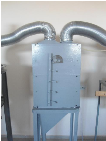
Рис. 2. Фотография инерционного концентратора
