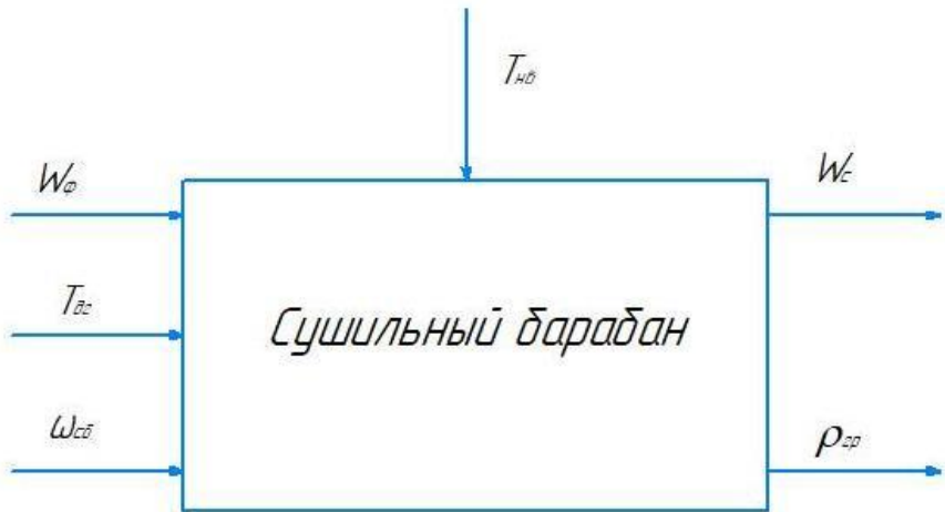
Рис.1 Структура процесса сушки как многомерного объекта управления
