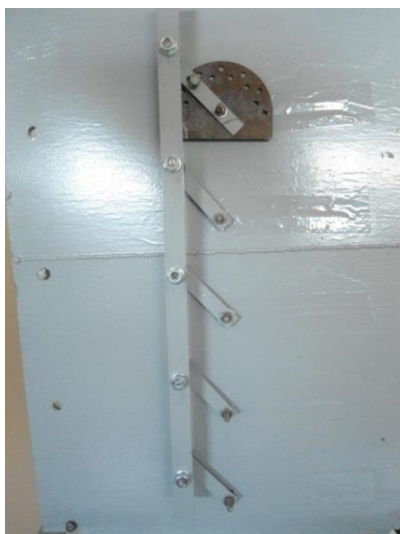
Рис. 4. Фотография системы жалюзийных элементов в инерционном концентраторе
