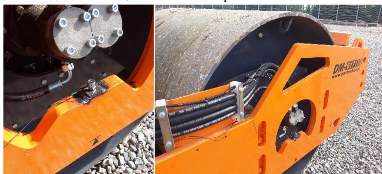
Рис. 2. Место установки акселерометра рамы вибровальца катка DM-617
