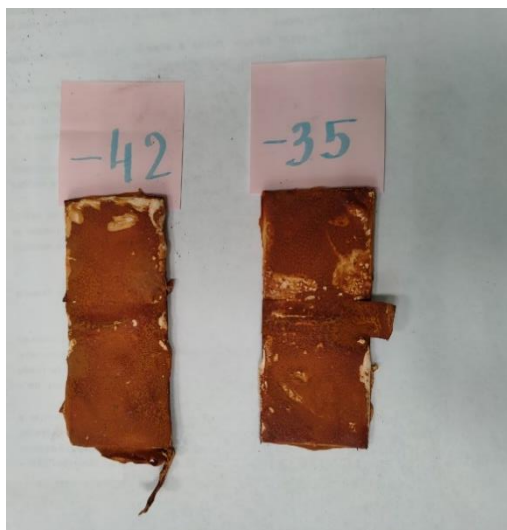
Рис. 5. Образцы покрытия сразу после извлечения из реагентов после 90-дневной выдержки
