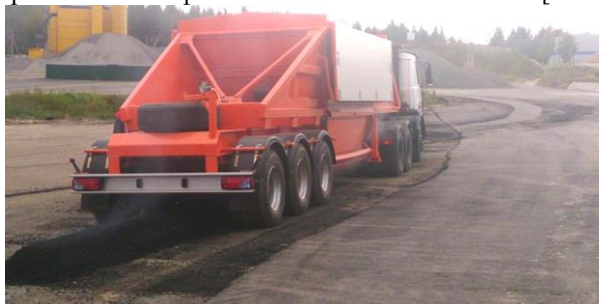
Рис. 3. Самосвал с донной разгрузкой на испытаниях
