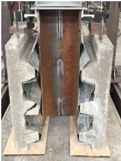
Рисунок 3.76 – Срез бетонного ребра в левой плите
