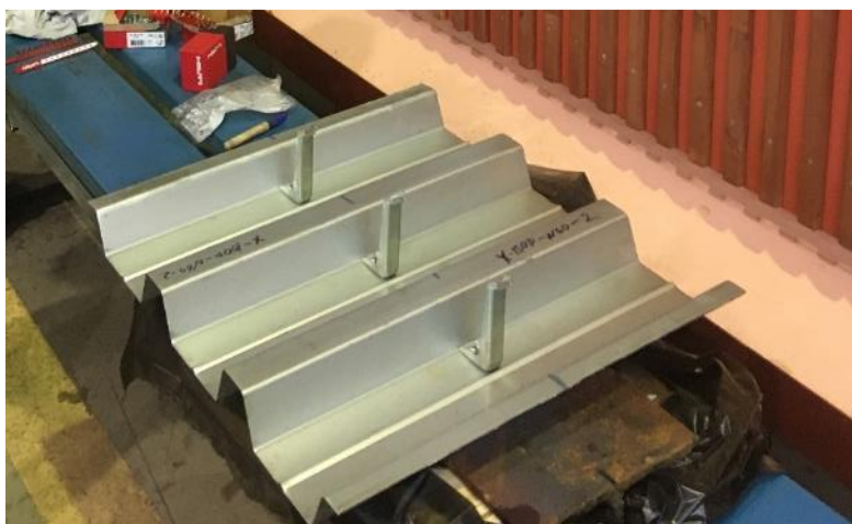
Рисунок 3.13 – Изготовление образца для третьего этапа
