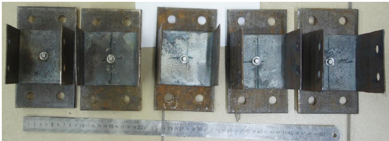
Рисунок 3.10 – Внешний вид образцов для испытания дюбель-гвоздей на растяжение
