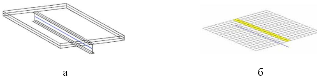
Рисунок 4.5 – Вариант компоновки расчётной схемы сталежелезобетонного перекрытия с плитами, устроенными по съемной опалубке [70]
