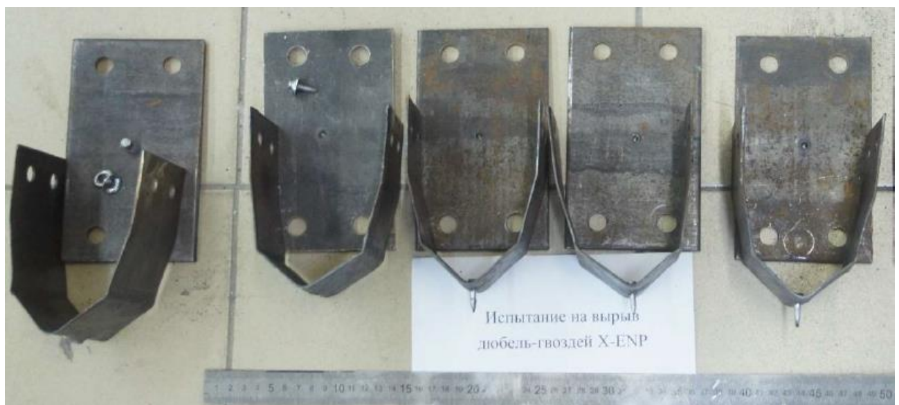
Рисунок 3.25 – Внешний вид образцов дюбель-гвоздей на растяжение после испытаний
