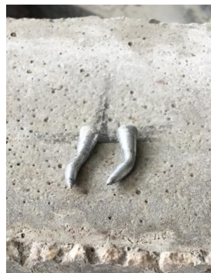
Рисунок 3.41 – Дюбели, вырванные из основания
