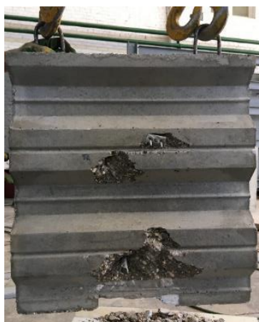
Рисунок 3.62 – Образец X120T-N44.1 после разрушения
