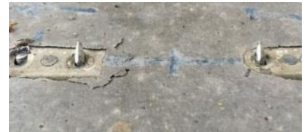
Рисунок 3.33 – Смешанный механизм разрушения
