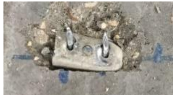
Рисунок 3.32 – Вырыв дюбелей из стального основания
