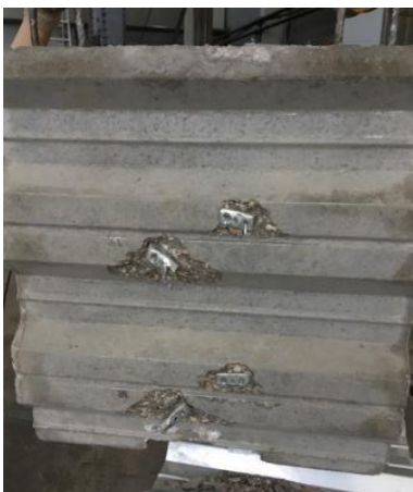
Рисунок 3.61 – Образец X120T-N44.3 после разрушения
