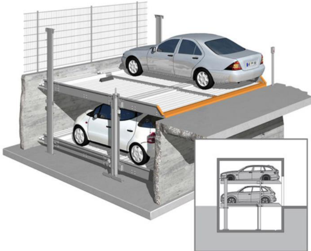
Рисунок Б.2 – KLAUS-системы хранения автомобилей в подвальных этажах МФЖК
