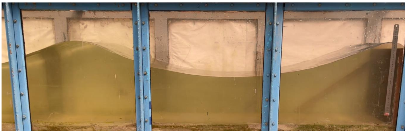
Рисунок 11 - Стоячая волна в момент перелива через модель вертикального ПГТС ( R_c = 2.7 м, уровень +0.0 см) при \frac{R_c}{h_i} \cong 0.426 .
