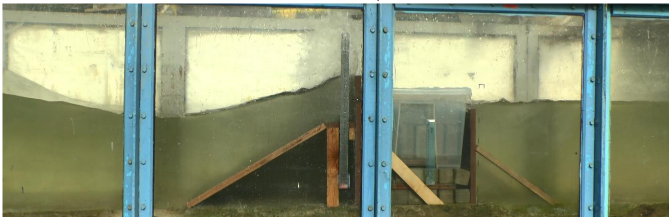
Рисунок 12 - Реализованная модель с ёмкостью из пластика с герметичной крышкой.
