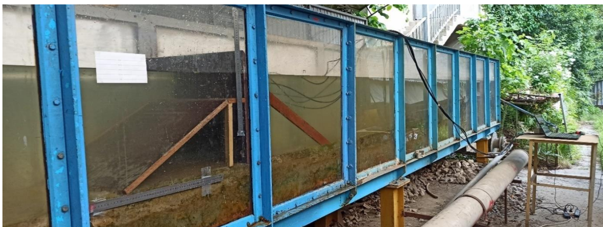
Рисунок 9 - Модель сооружения с бермой (вид сбоку по направлению от волнопродуктора), измерительное оборудование и компьютер с установленным ПО для сбора и визуализации данных, получаемых с датчиков давления Keller PR-41X.
