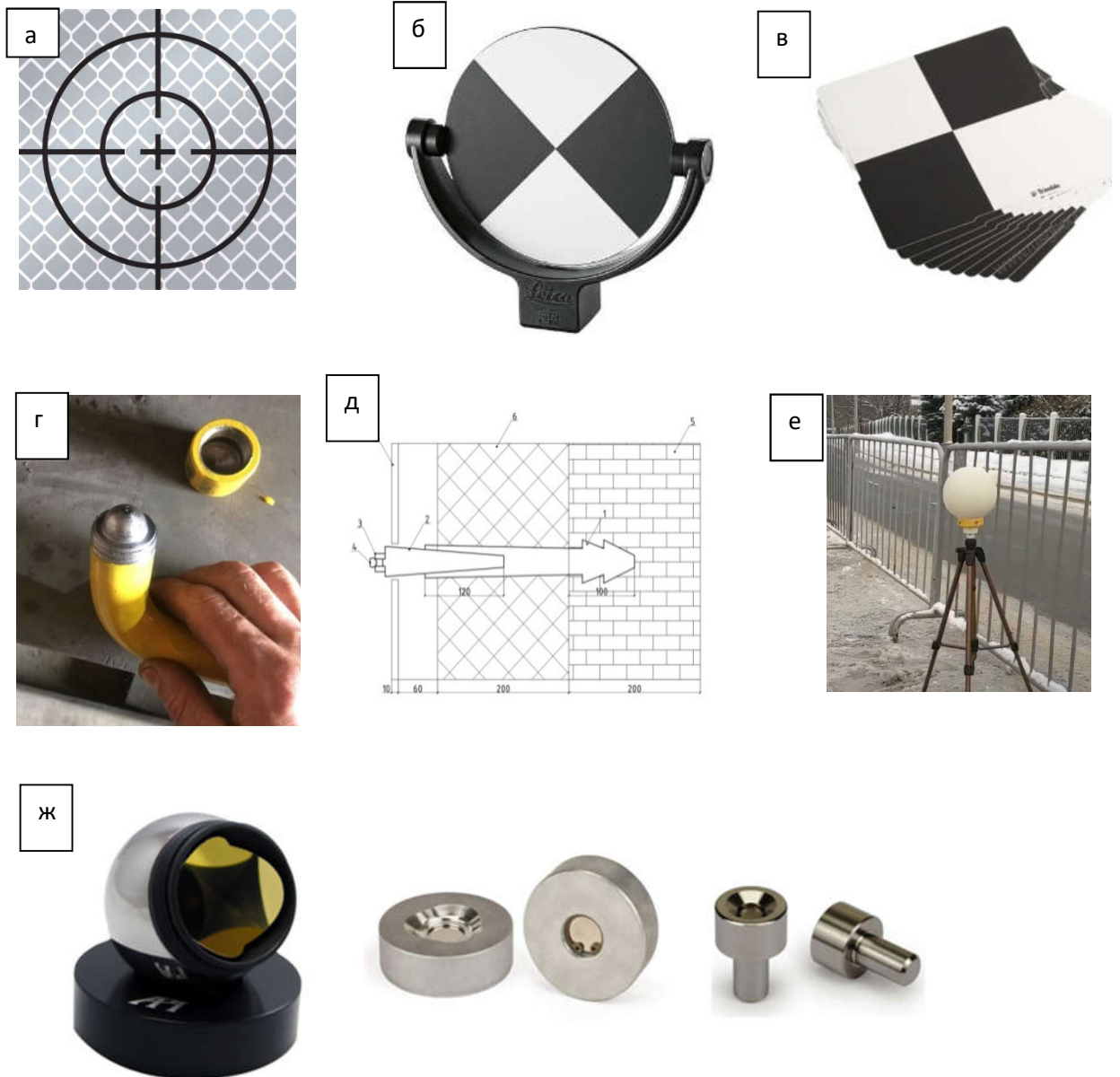
Рисунок 3.13 – Основные виды марок при геодезических наблюдениях. а-в – плоские контрастные марки; г – Г-образная по РД 34.21.322-94 [124], д – авторская марка по патенту [114]; е – специальные сферы со встроенным отражателем внутри; ж – отражатели для лазерного трекера
