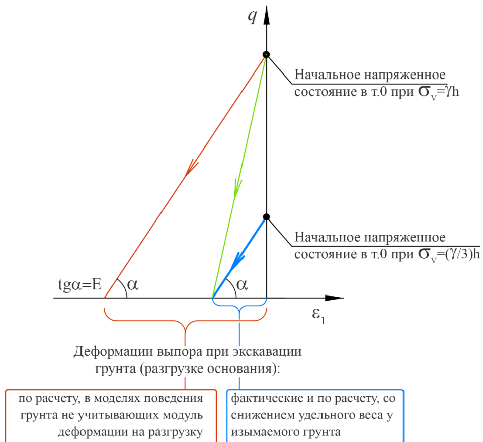
Рисунок 2.3. График зависимости деформаций от напряжений при экскавации грунта (разгрузке основания), в том числе для расчета со снижением удельного веса изымаемого грунта (синий график)
