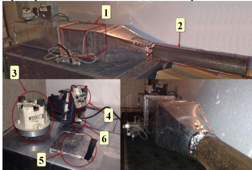
Рисунок 3 – Испытательная установка. 1 – место расположения образца, 2 – измерительный патрубков, 3 – вентилятор, 4 – блок регулировки, 5 – регулировочное окно, 6 – кнопка включения/выключения.
